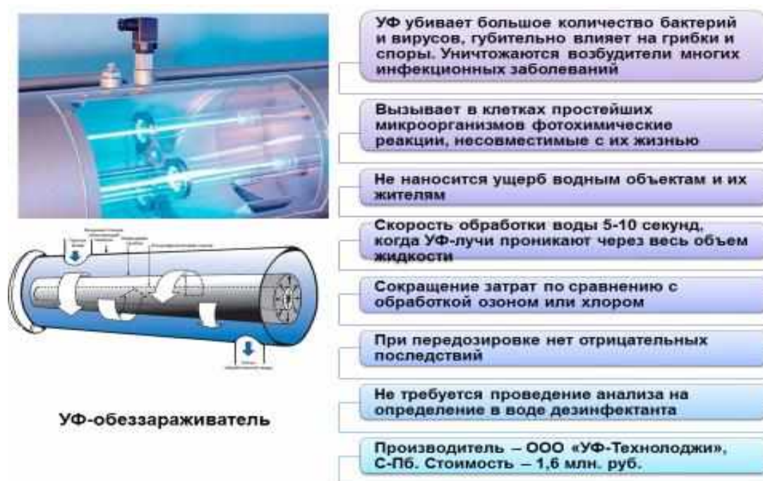
Рис. 12. Внешний вид УФ-обеззараживателя и его достоинства
