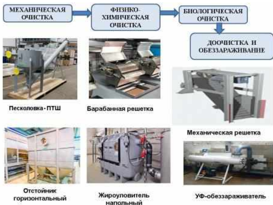
Рис. 3. Этапы очистки сточных вод птицефабрик и применяемое оборудование
