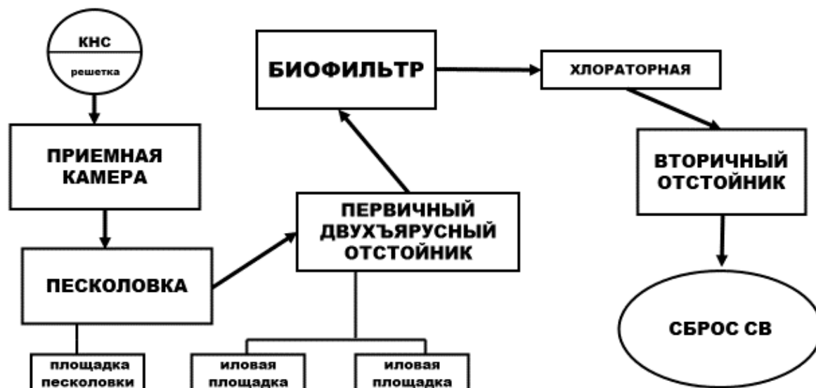
Рис. 5. Технологическая схема очистки сточных вод
