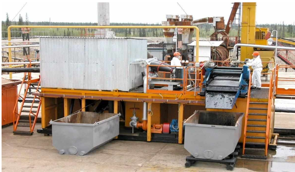
Рис. 12. Установка для получения грунтошламовой смеси
