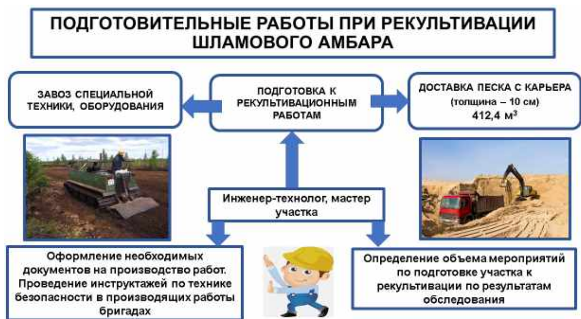
Рис. 8. Подготовительные работы при рекультивации шламового амбара
