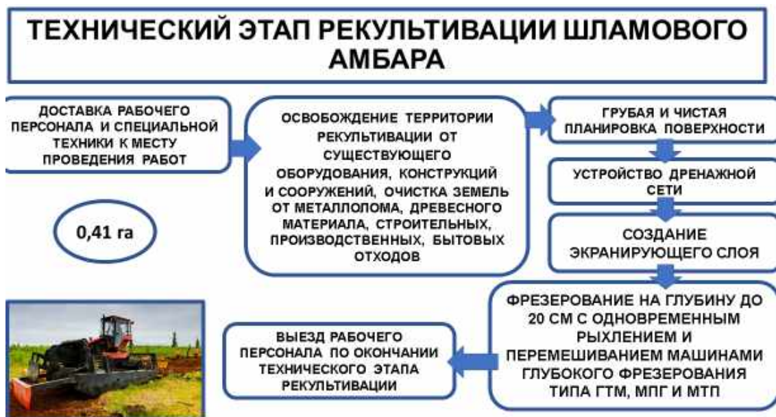
Рис. 9. Стадии технического этапа рекультивации шламового амбара
