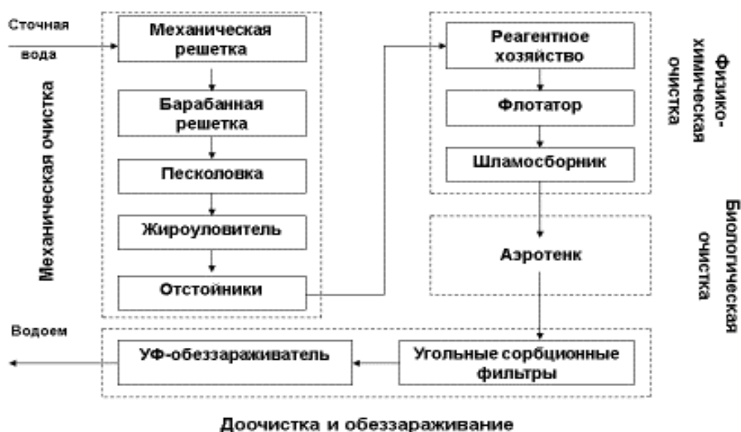
Рис. 4. Классическая технологическая схема очистки сточных вод птицефабрик
